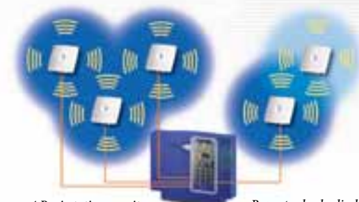
max. 4 Basisstationen mit 2-Draht-Verbindung an Controller-Modul
